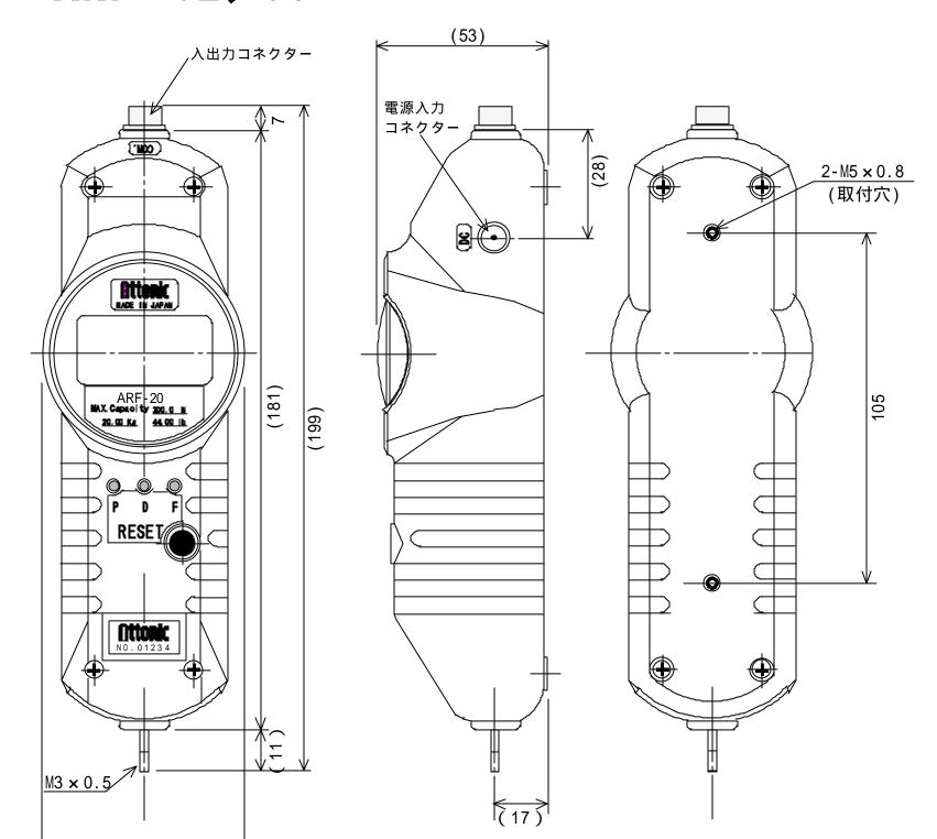
取付寸法とネジサイズ ・ピッチ105(2 - M 5 × 0 . 8)
