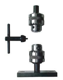
圧縮・引張用のチャックです。 細い丸棒等のワークに適合します。
