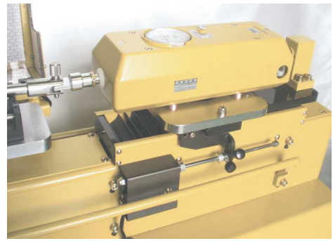
横型荷重測定スタンドに取り付けて使用しているところ
